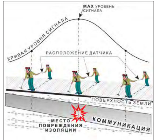
применение датчик-определителя дефектов коммуникации (ДОДК) методом максимум
