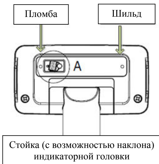
Рисунок 14.1 – Расположение поверочной пломбы весов
