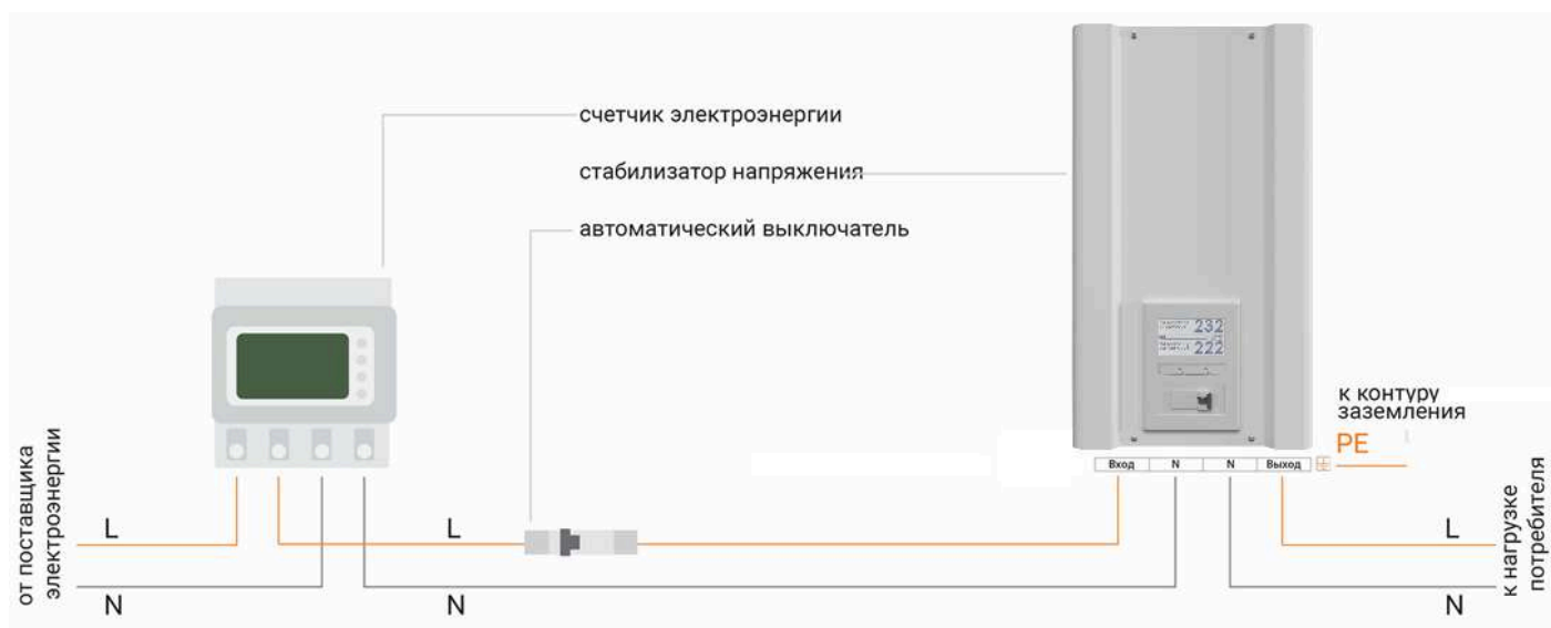
Рисунок 6. Схема подключения стабилизатора к однофазной сети
