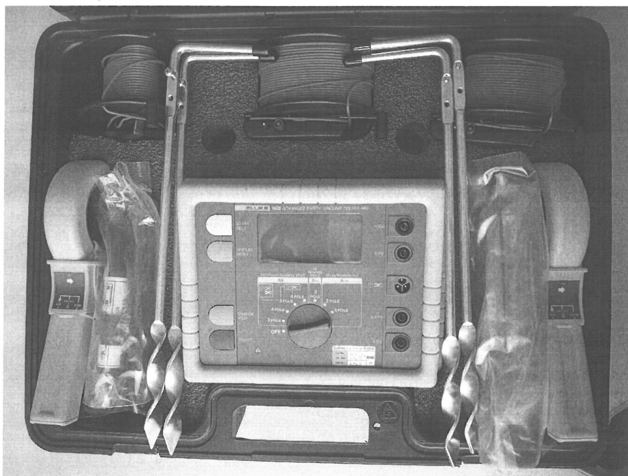
Рисунок 3 - Тестер Fluke 1625 с полным комплектом принадлежностей.
