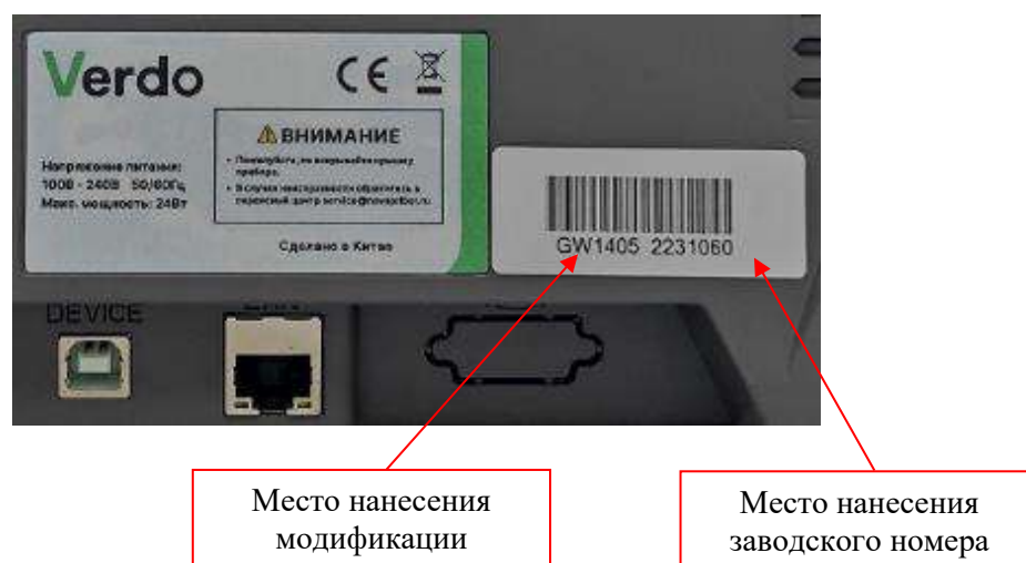
Рисунок 4 – Фрагмент задней панели генераторов с этикеткой
