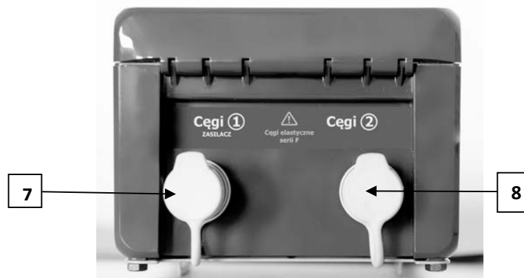
Рис.2. Расположение разъемов в сигнализаторе MPU-1.
