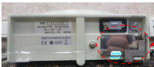
Рисунок 2 - Схема пломбировки весов от несанкционированного доступа
