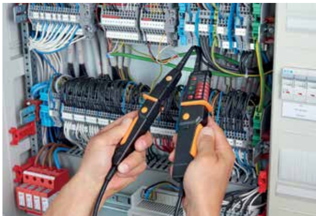
Измерение напряжения в распределительном щитке.
