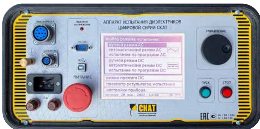
Рисунок 7. Внешний вид передней панели блока управленй.
