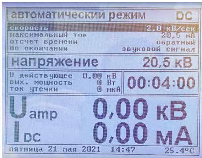
Рисунок 11. Экран аппарата в автоматическом режиме.
