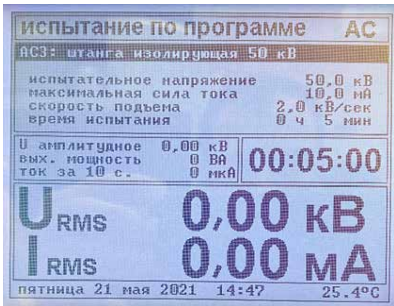
Рисунок 12. Экран аппарата в режиме испытания по программе.
