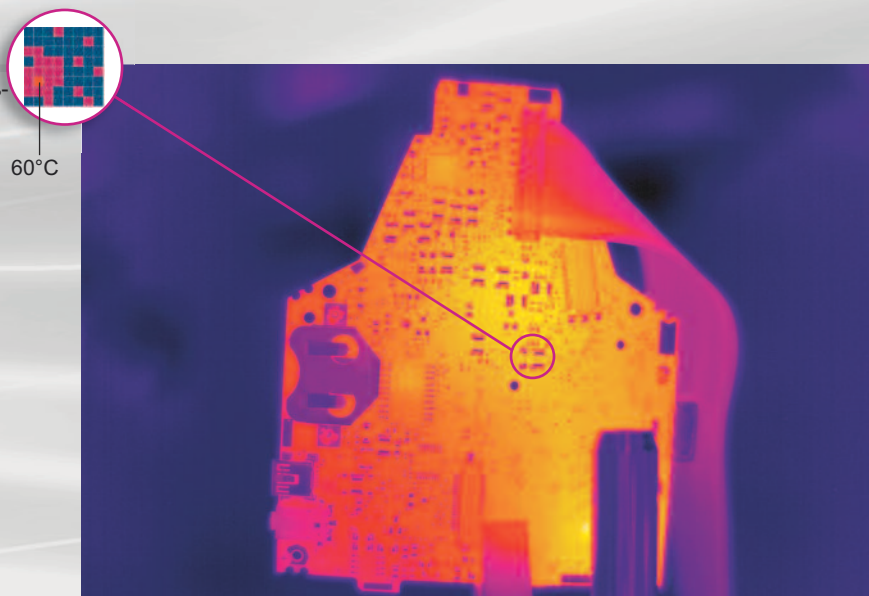
Термограмма в мегапиксельном качестве, созданная с помощью технологии SuperResolution —> 1280 x 960 пикселей
