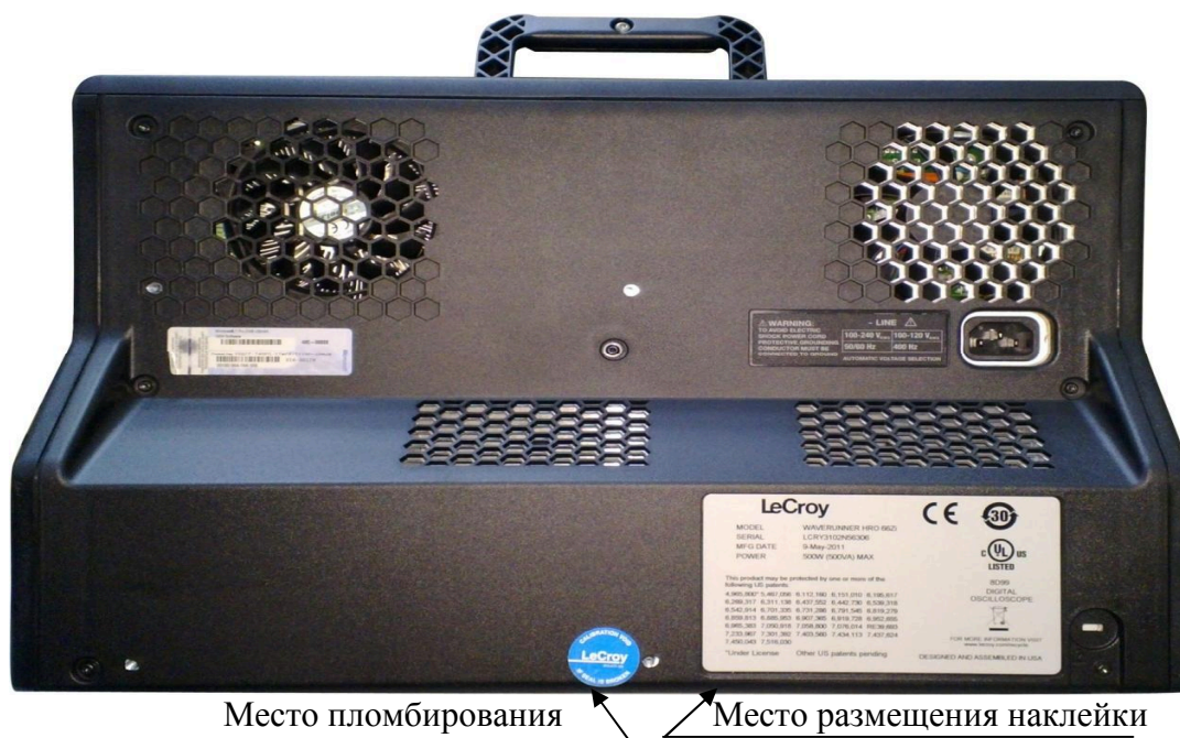
Рисунок 3 - Схемы для размещения наклейки и пломбировки от несанкционированного доступа
