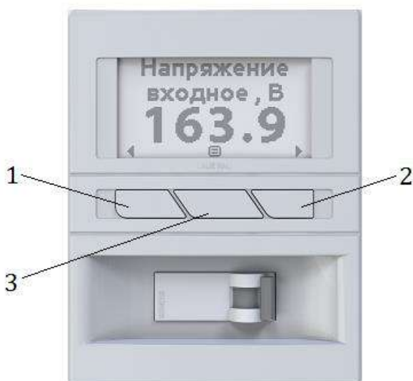
Рисунок 12. Расположение кнопок управления на панели управления Назначение кнопок следующее:
