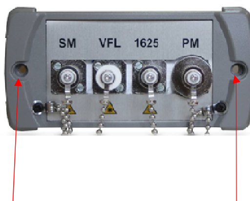
Рисунок 4 - Вид сбоку (оптические разъемы)
