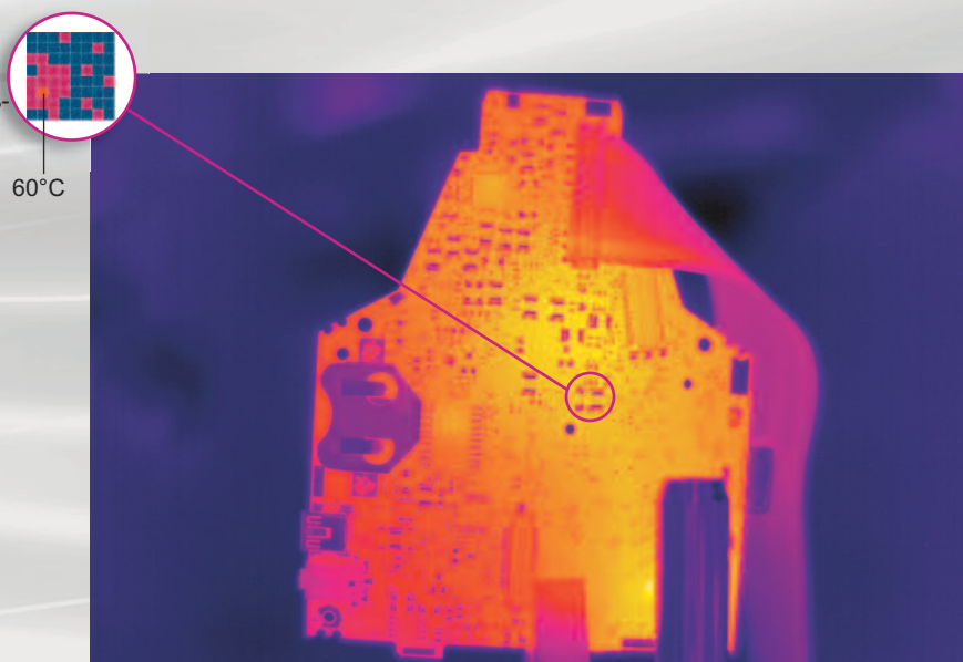
Термограмма в мегапиксельном качестве, созданная с помощью технологии SuperResolution —> 1280 x 960 пикселей
