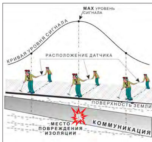
применение датчик-определителя дефектов коммуникации (ДОДК) методом max
