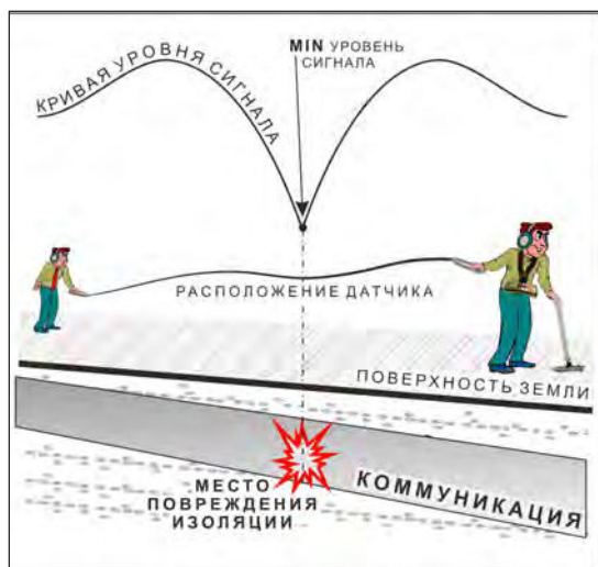
применение датчик-определителя дефектов коммуникации (ДОДК) методом min
