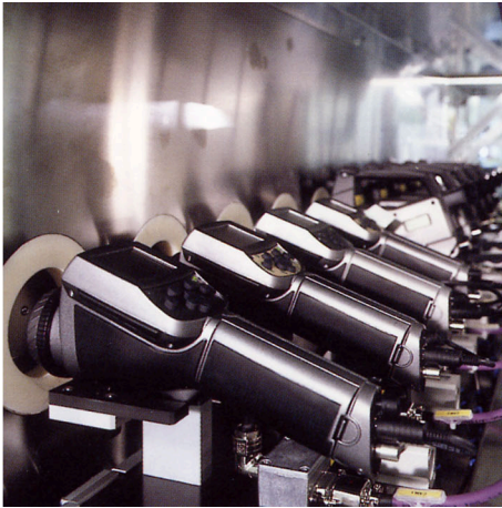
Рисунок 17.4 СЛЕВА: Тестирование инфракрасных камер в климатической камере; СПРАВА: Робот для тестирования и калибровки камеры
