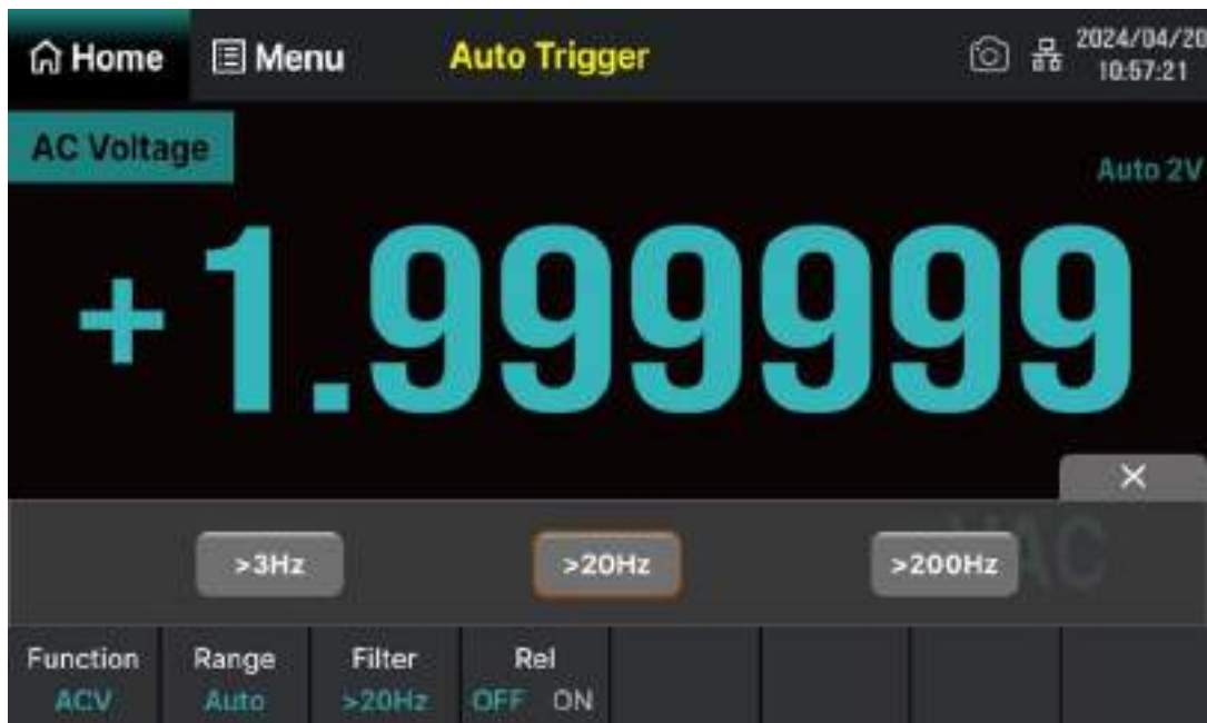
Рис.Настройка частотного фильтра
