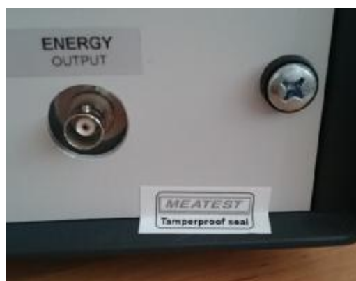
Рисунок 2 – Фотография пломбировки калибраторов
