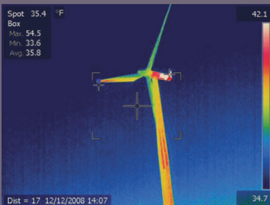
ИК-изображение ветровой турбины, полученное с земли
