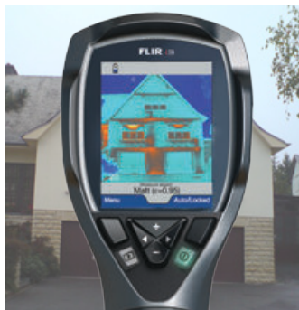
FLIR i3, измерение температуры в 3 600 точках
