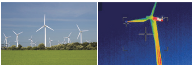
ИК-изображение ветровой турбины, полученное с земли
