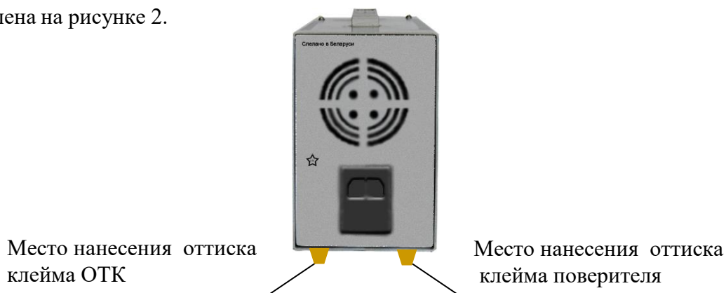
Рисунок 2 – Место нанесения оттиска клейма поверителя и оттиска клейма ОТК (вид источника питания сзади)
