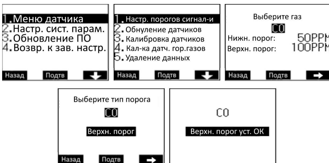
Рис. 5. Настройка порогов сигнализации
