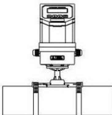
Установка на трубопроводе
